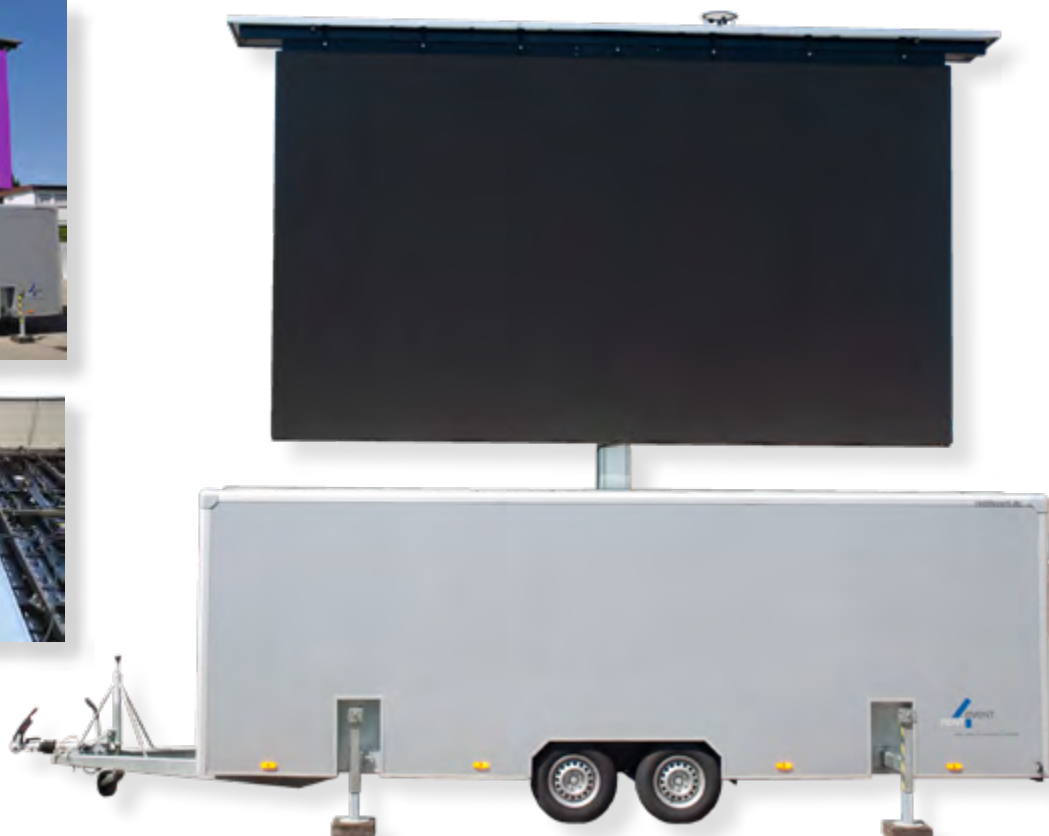
LED Anhänger mit 17,7 m 2 und 6 mm Pixelpitch
